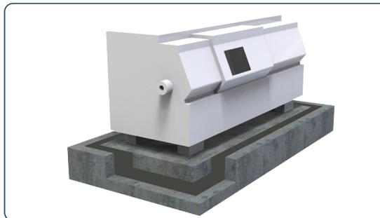
Cette mesure s'applique lorsque les vibrations en provenance des fondations nuisent par ex. au bon fonctionnement d'une machine sensible. En tant que couche intermédiaire élastique souple, les appuis en élastomère se posent sur toute la surface.
