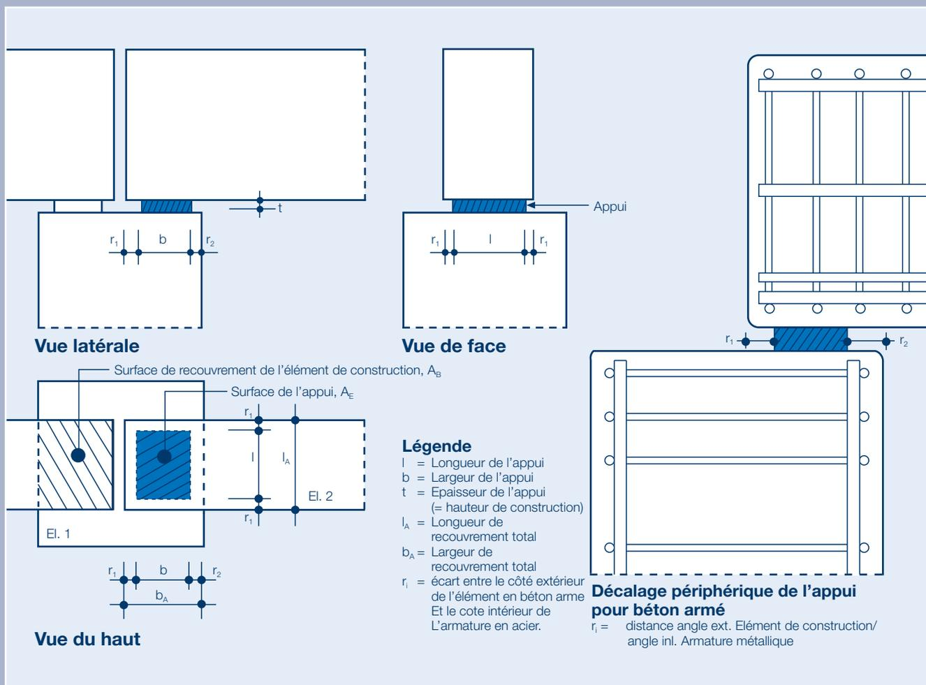
Surface maximum d'un appui en élastomère pour la construction en béton armé (attention au décalage périphérique impose selon les normes de construction en vigueur). Pour les éléments en bois ou en acier, le décalage périphérique de l'appui en élastomère doit être au moins 3 cm.
